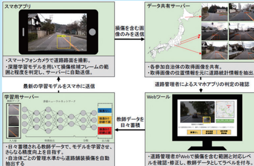
図表3-5 道路の損傷箇所等の把握
