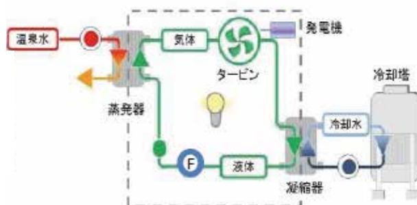
図 5-5 温泉バイナリー発電の仕組み (出典：一般社団法人 小浜温泉エネルギー 視察資料)
